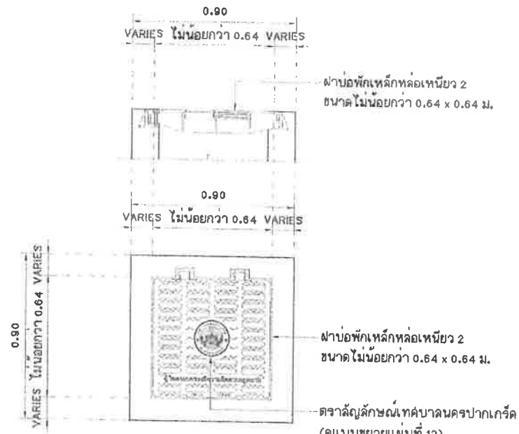
แบบขยายฝาบ่อพักเหล็กหล่อเหนียว 2 มาตราส่วน 1:20
