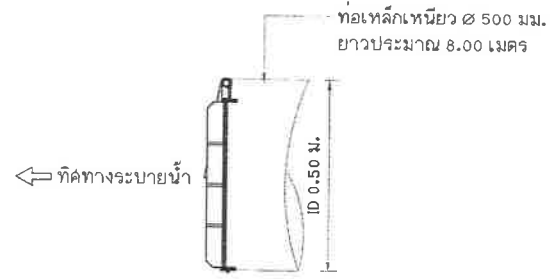
แบบขยายรูปด้านข้าง FLAP GATE สำหรับท่อ ID Ø 500 มม. มาตราส่วน 1 : 25
