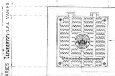
แบบขยายฝาบ่อพักเหล็กหล่อเหนียว 2 มาตราส่วน 1:20
