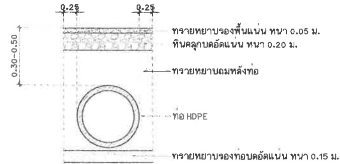
ท่อระบายน้ำ HDPE
