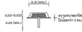
รูปด้านข้างแสดงหมุดสะท้อนแสงอลูมิเนียมอัลลอยด์ชนิดลงด้าน
