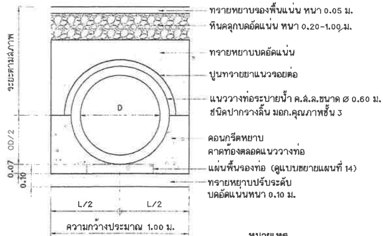
แบบขยายการวางท่อระบายน้ำ คสล. มาตราส่วน 1 : 20
