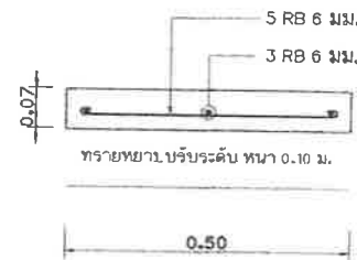
แบบขยายรูปตัดแผ่นพื้นรองท่อ มาตราส่วน 1 : 10
