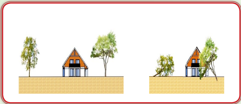
(ง) ความเสียหายของอาคารจากการก่อสร้างใกล้ต้นไม้ใหญ่
