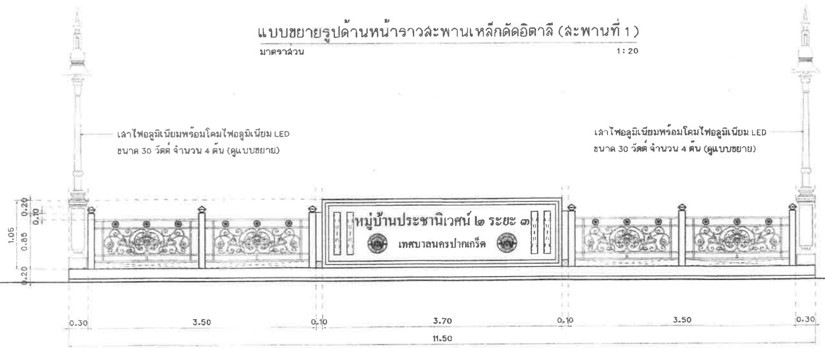
รูปด้านหน้าราวสะพาน คลล.พร้อมป้าย (สะพานที่ 1) มาตราส่วน 1 : 40
