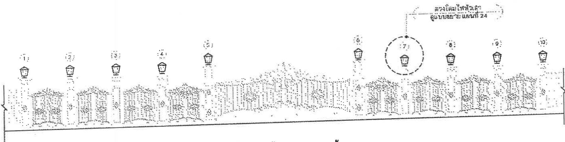
รูปด้าน (ติดตั้งโคมไฟหัวเสารั้ว) SCALE 1:100
