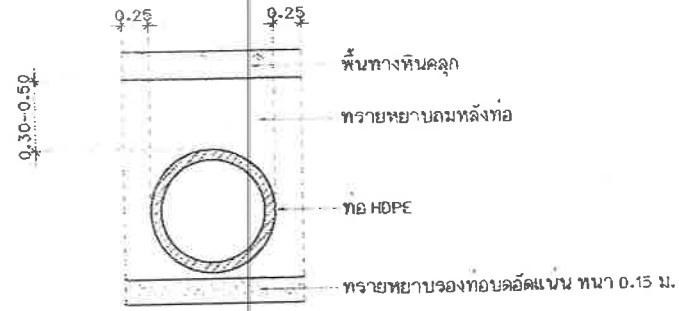
ท่อระบายน้ำ HDPE
