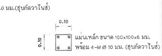
แบบขยายแผ่นเหล็กยึดราวกันตก มาตราส่วน 1:20
