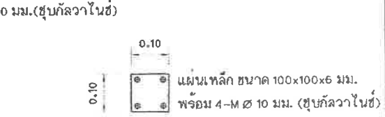
แบบขยายแผนเหล็กยึดราวกั้นตึก มาตราส่วน 1:20
