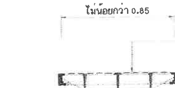
ฝาบ่อพักเหล็กหล่อเหนียว 2 ขนาดไม่น้อยกว่า 0.85 x 0.85 ม. (รับน้ำหนักไม่น้อยกว่า 25 ตัน)
