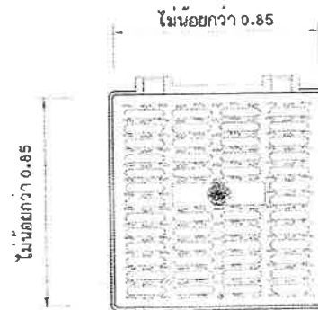
ฝาบ่อพักเหล็กหล่อเหนียว 2 ขนาดไม่น้อยกว่า 0.85 x 0.85 ม. (รับน้ำหนักไม่น้อยกว่า 25 ตัน)
